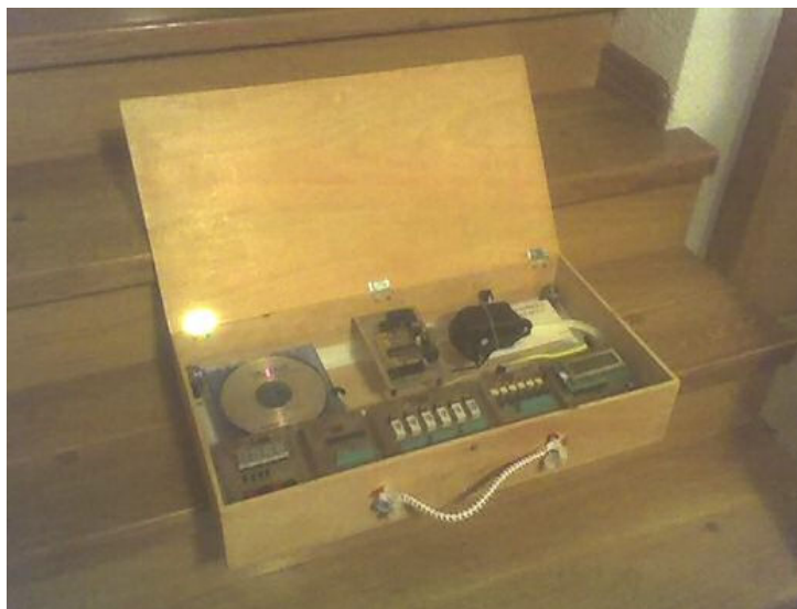
Slika 2: Izdelani MEM kot učilo, vgrajeni v preprost lesen kovček.
