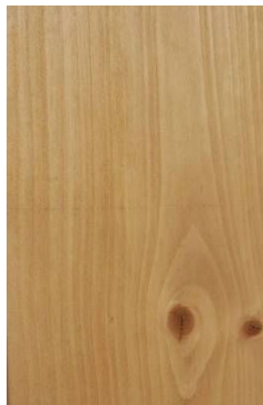
Slika 3: Regratov izvleček na smrekovini (6 nanosov)
