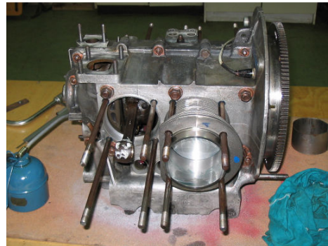
Slika prikazuje motor po fazi: sestava batov in vstavljanje valjev.
