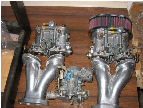
Slika prikazuje motor po fazi: popolnoma spremenjena uplinjača in sesalni kanali pred vgradnjo.
